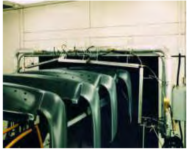
汽车保险杠喷漆前的除静电、除尘
